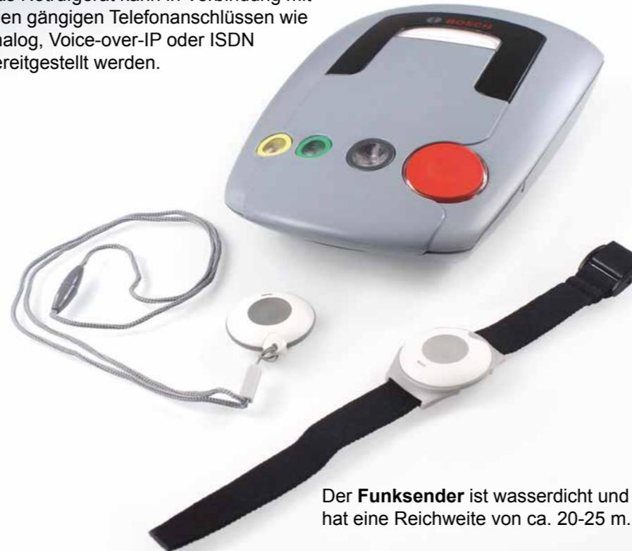
Der **Funksender** ist wasserdicht und hat eine Reichweite von ca. 20-25 m.
